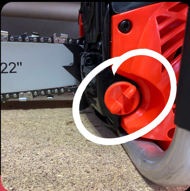
Este es el tanque de lubricación para barra y cadena.
